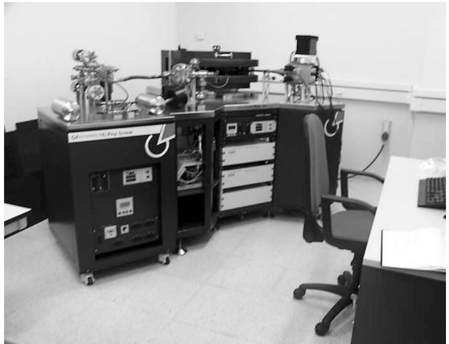
fig 1. Espectrómetro de Masas de Gases Nobles HELIX acoplado a parte de la línea de purificación de gases.
