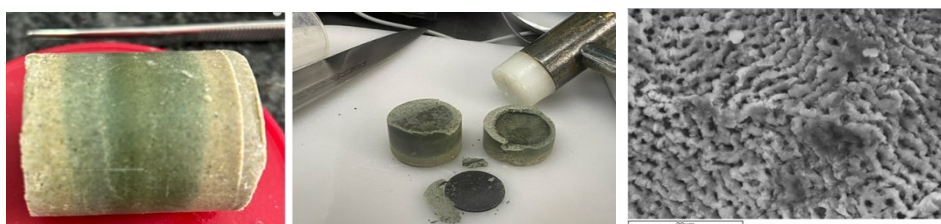
Fig 3. A y B) Detalle de la bentonita Febex compactada a 1.4 \text{ g/cm}^3 tras el desmantelamiento del ensayo estático a 80 \text{ °C} ; C) Imagen de SEM de los oxo-hidróxidos de Fe formados en la superficie del metal de acero al carbono de Nagra.
