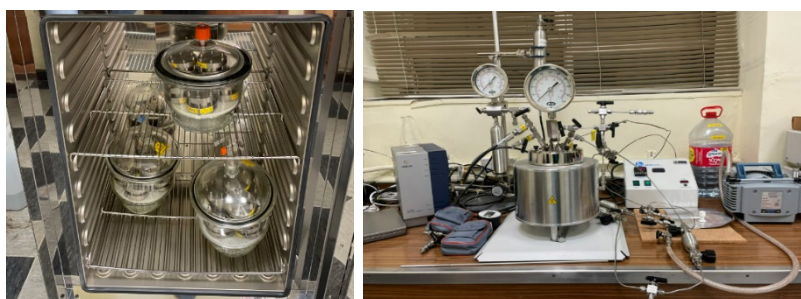
Fig 1. A) Ensayos de corrosión dinámicos y B) Ensayos de corrosión estáticos.
