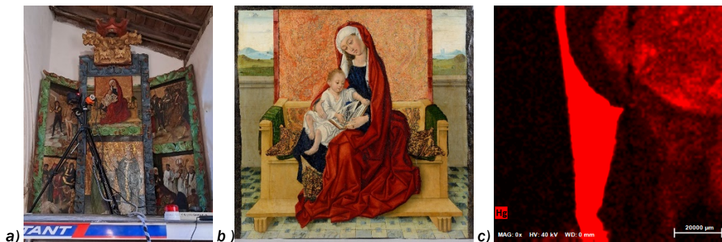
Fig 1. (a) Retablo de San Cornelio y San Cipriano durante su estudio mediante fluorescencia de rayos X. (b) Detalle de la tabla central representando a la Virgen con el Niño (Fuente: CCRBC). (c) Mapa de la presencia de mercurio (Hg) en un detalle del rostro y manto de la Virgen.
