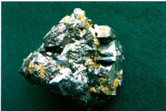
FIGURA 1: La hematites (6) y su variedad el ocre rojo (2 o 1) buen ejemplo de variación de dureza dependiendo del grado de alteración que descohesiona las moléculas que forman su red cristalina.
