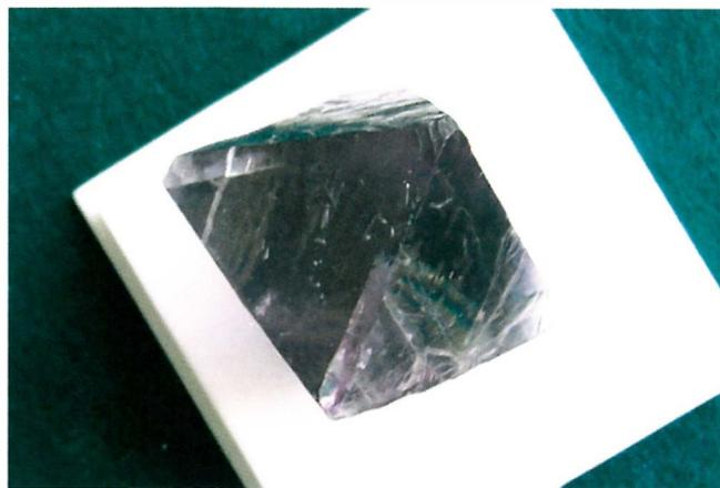
FIGURA 3: Cristal de fluorita octaédrico obtenido de la rotura por exfoliación de un cristal de hábito cúbico.
