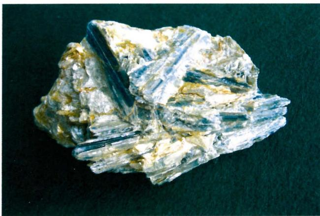
FIGURA 2: La cianita es un claro ejemplo de anisotropía respecto a la propiedad de la dureza, presentando el grado 7 si la ensayamos perpendicularmente al eje c del cristal o dureza 3 si el ensayo se realiza a lo largo del mencionado eje.
