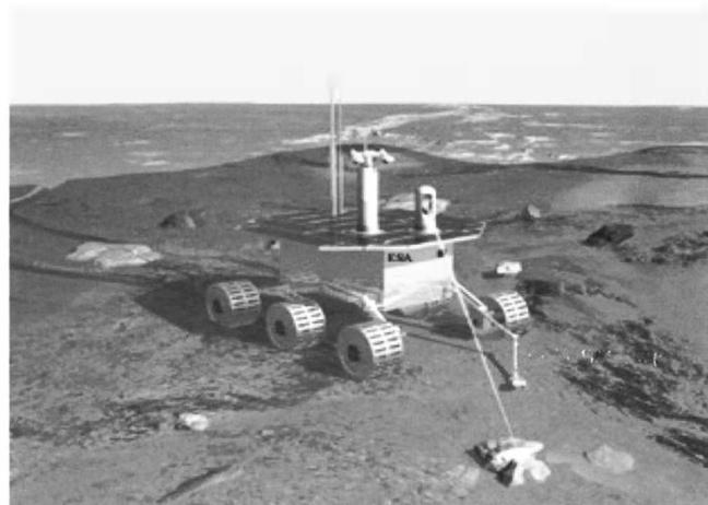
FIGURA 4: Representación artística del proyecto EXLIBRIS. Un instrumento Raman-LIBS integrado para la caracterización química y estructural de minerales y posibles biomarcadores en superficies planetarias
