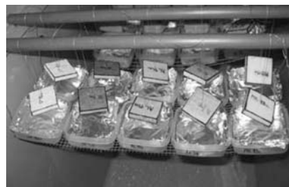
fig 1. Disposición de las muestras en la cámara salina de envejecimiento acelerado. Las muestras fueron colgadas para permitir una alteración homogénea por todas las caras de las tabletas
